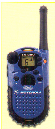
Bild 7: Wachablösung: die neuen PMR-Funkgeräte erlauben Reichweiten bis 6 km und ergänzen LPD nach oben.
