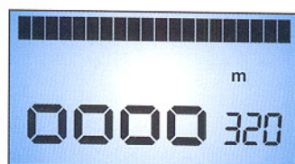
Bild 7: So zeigt der VAM 200 fehlenden Empfang des Telemetriesenders an.
