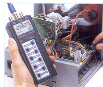
Frequenzzähler im ▶ Taschenformat bis 1,3 GHz für Frequenz-, Periodendauer- und Pulsbreiten- messung sowie Ereigniszählung Seite 47
