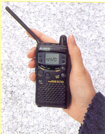
Bild 2: So mini ist LPD - eine Handvoll HighTech, die viel von ausgereifter kommerzieller Amateurfunktechnik übernommen hat.
