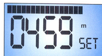
Bild 9: Die Festsetzung der Alarmhöhe erfolgt über die SET-Funktion.
