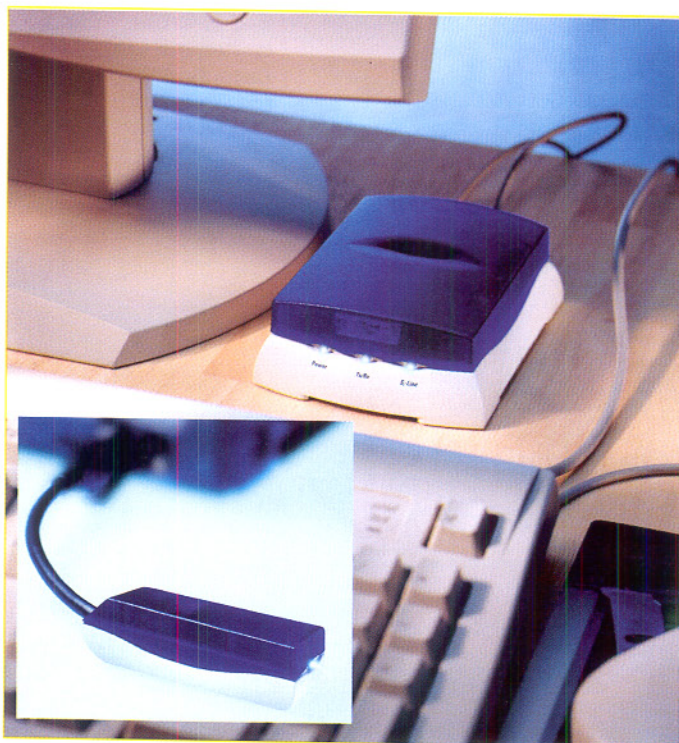
Bild 9: Kein lästiges Modemkabel mehr - Bluetooth macht Datenfunk bis zu 10 m möglich, hier das ELISA-Modem „Microlink ISDN Bluetooth“.
