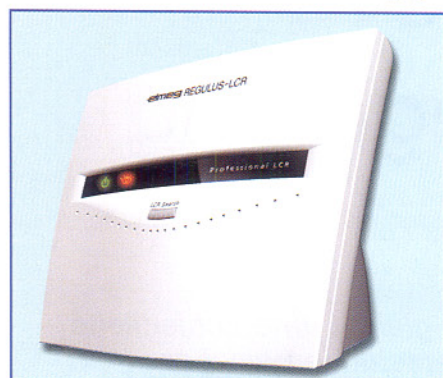
Bild 18: Auch im ISDN immer konstengünstigst telefonieren - ein Least Cost-Router am externen So-Bus macht's möglich.
